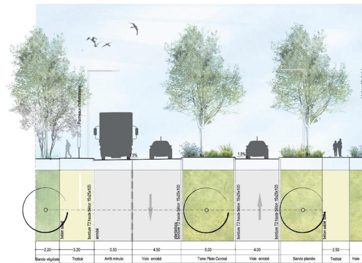
Coupe type de la voie d'accès en entrée du PAE de la Dombes
