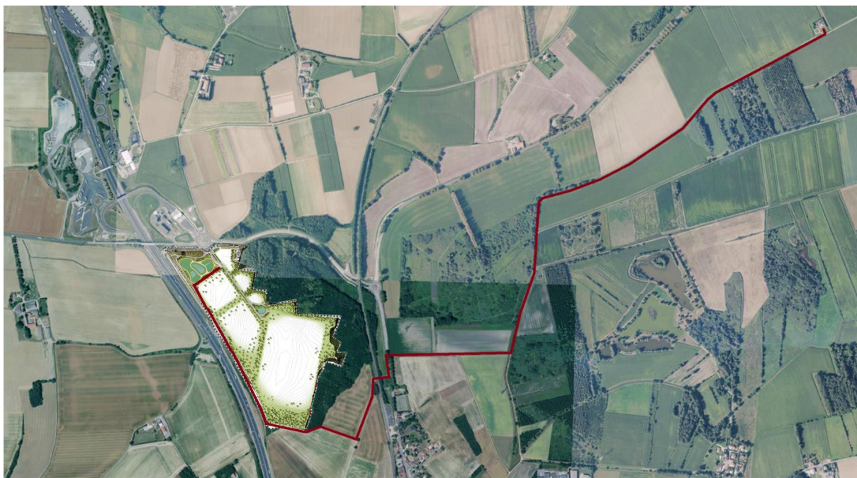
Tracé du réseau de refoulement définitif vers la STEP de Mionnay (et liaison piétonne vers la halte ferroviaire des Echets)
