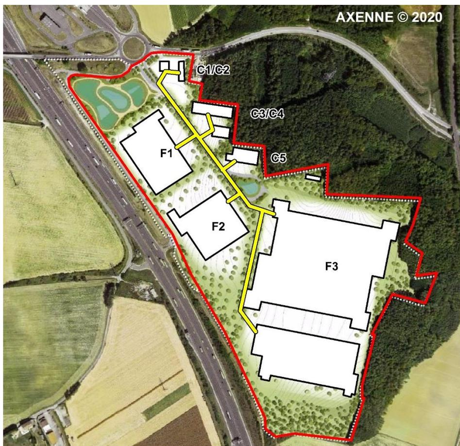
Figure 3 : Tracé et extensions du réseau de chaleur potentiel
