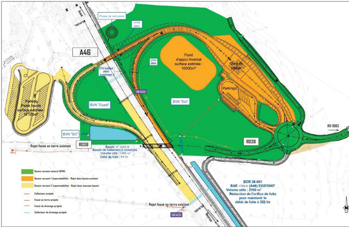
Assainissement pluvial du 1/2 échangeur de l'A46
