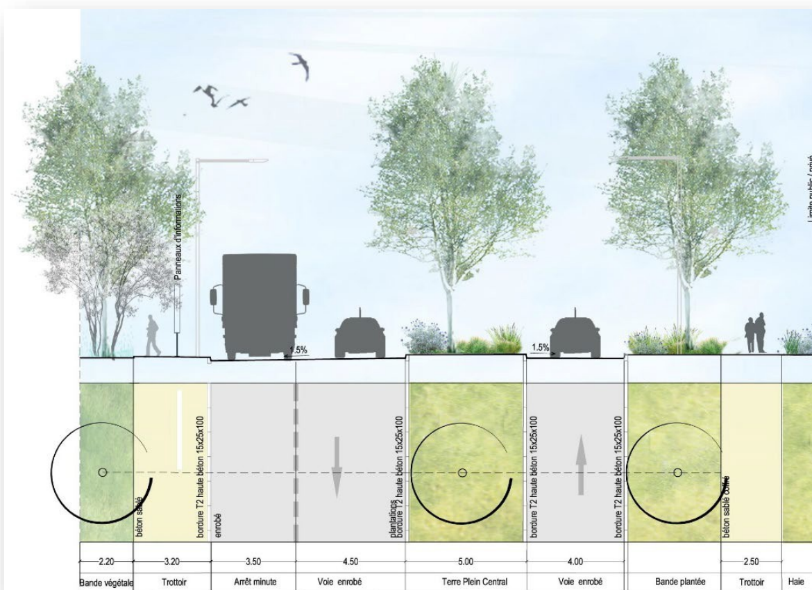
Profil type de la Voirie en entrée de ZAC
