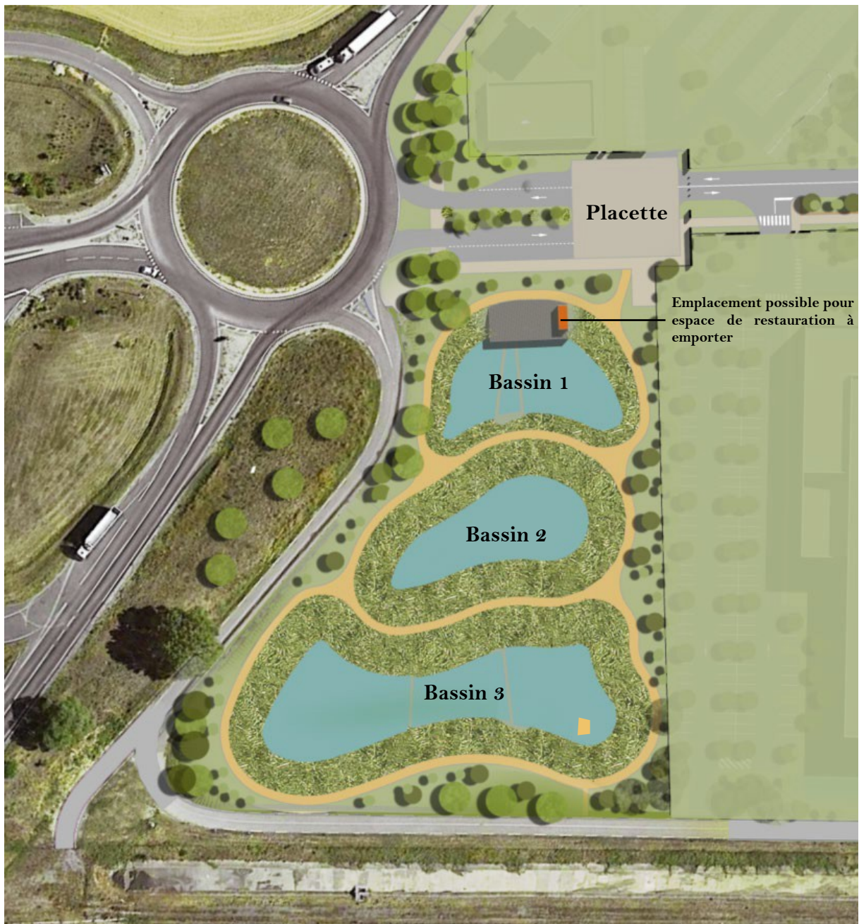
Bassins de rétention Ouest
